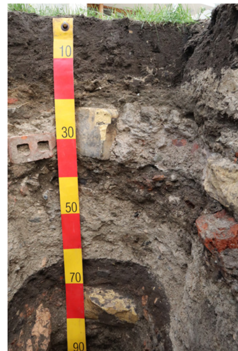
Entsiegelter Boden mit hohen Trümmerschnittgehalten Würde der Grobboden in diesem Profil nicht berücksichtigt, käme es zu einer 15-prozentigen Überschätzung des organischen C-Speichers; das entspricht 1,2 kg/m 2 bis 1 m Tiefe.
