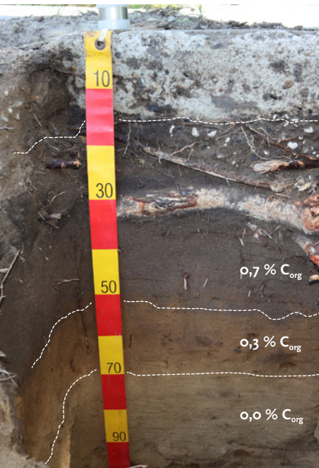
Vollversiegelter Mineralboden Boden in Berlin-Köpenick mit organischen C-Gehalten im Ober- und Unterboden. Im Oberboden ist auch ein geringer Gehalt von 0,1 Masse-% technogenem C_{org} zu finden.
