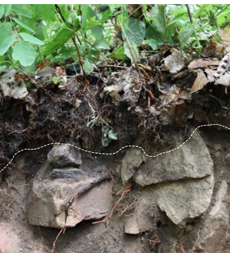
Mächtige Humusaufgabe auf einem entsiegelten Boden im Grünwald Humusaufgaben enthalten meist keinen technogenen organischen Kohlenstoff.
